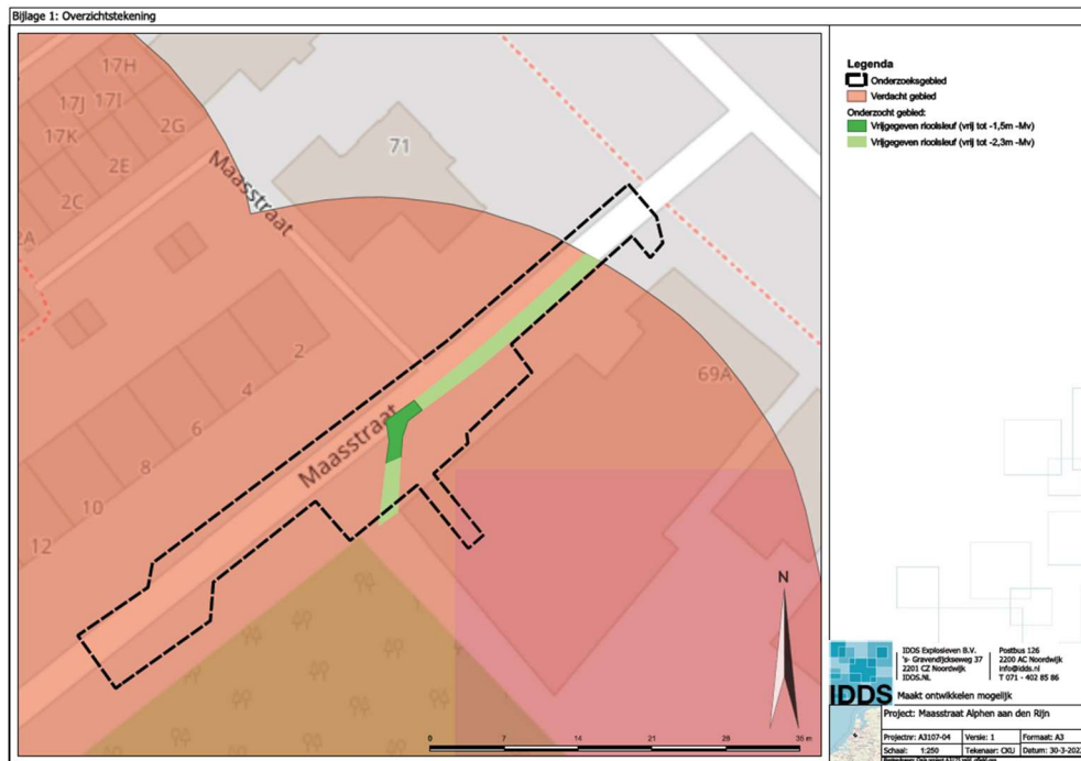
Figuur 11. De vrijgegeven rioolsleuf behorende bij het onderzoek van IDDS Explosieven B.V.. Het donkergroene deel is tot 1,5 meter beneden maaiveld vrijgegeven, en het lichtgroene deel tot 2,3 meter beneden maaiveld.
