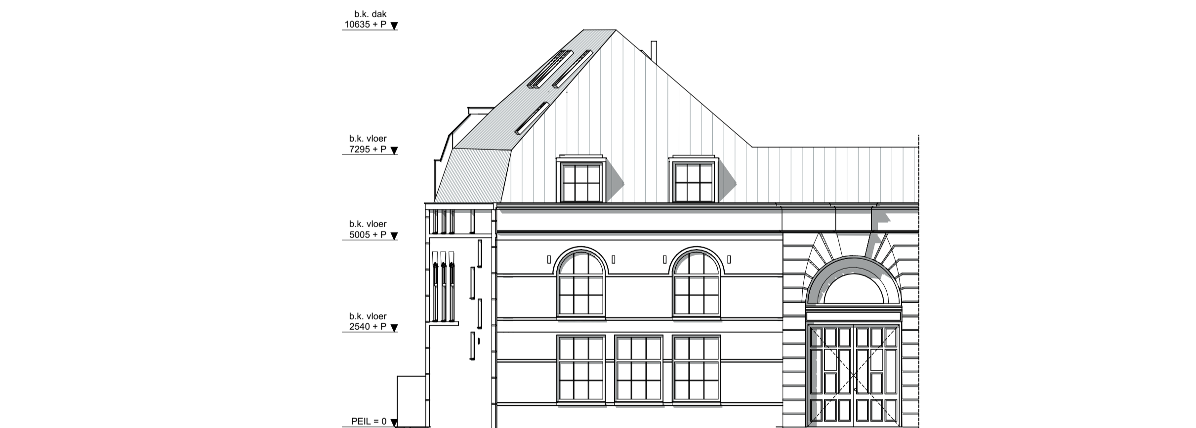
01 Bestaande toestand Voorgevel 1:100
