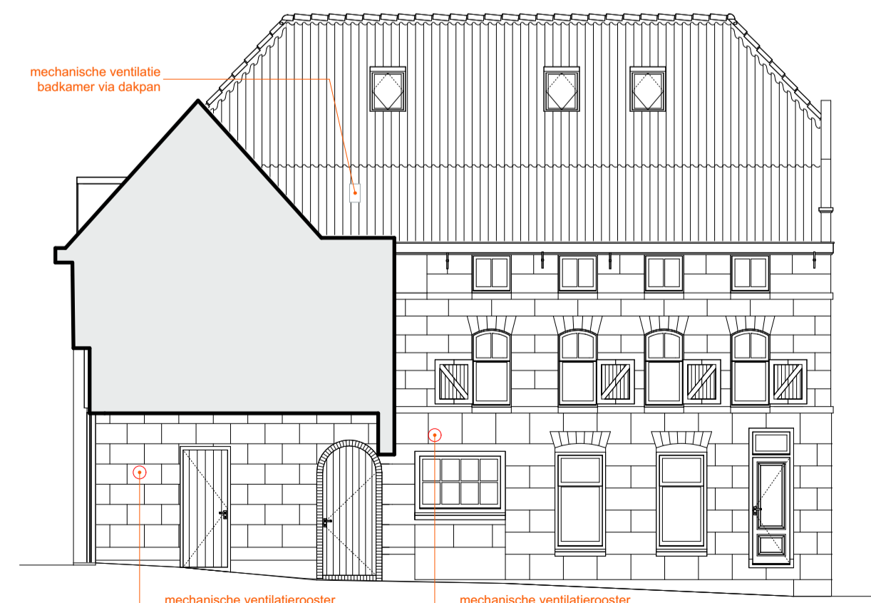
05 Nieuwe toestand Linker zijgevel - binnenplaats 1:100
