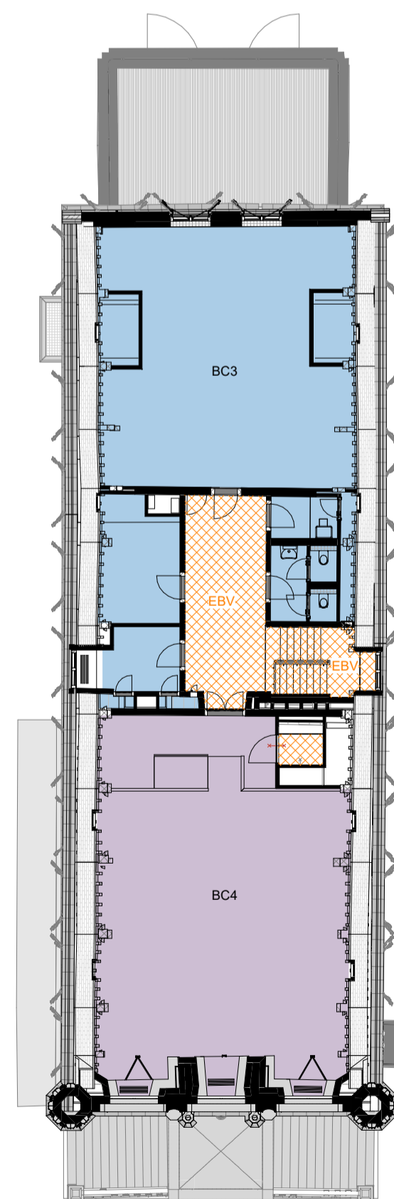
B.C. tweede verdieping Brandcompartimentering (BC) ■ BC3 122 m² (totaal 391 m²) ■ BC4 123 m² (totaal 270 m²) ■ EBV
