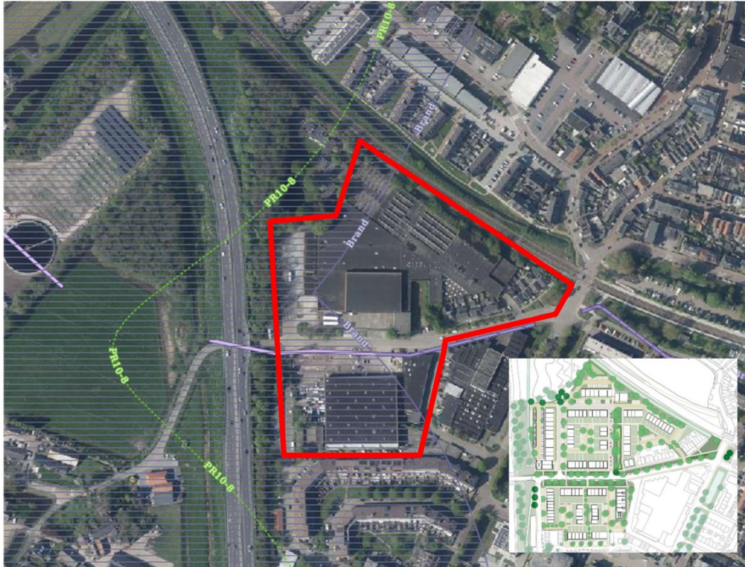
Afbeelding 3 Ligging buisleiding (paarse lijn) ten opzichte van plangebied (rode omlijning) (bron: Atlas Leefomgeving)
