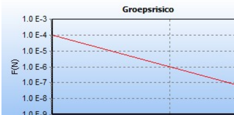
5.4 Figuur 5.4 FN curve voor 8028_leiding-W-501-03-deel-1 van N.V. Nederlandse Gasunie voor de kilometer tussen stationing 0.00 en stationing 0.00
