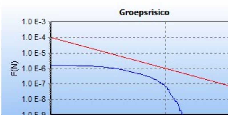
5.5 Figuur 5.5 FN curve voor 8028_leiding-W-517-01-deel-1 van N.V. Nederlandse Gasunie voor de kilometer tussen stationing 4110.00 en stationing 5110.00
