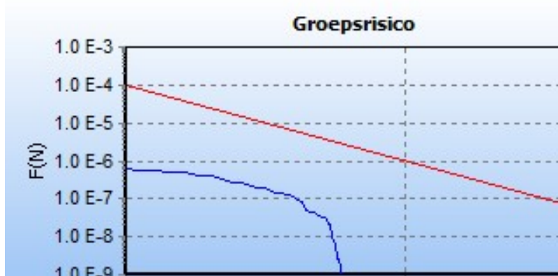
5.7 Figuur 5.7 FN curve voor 8028_leiding-W-521-01-deel-1 van N.V. Nederlandse Gasunie voor de kilometer tussen stationing 0.00 en stationing 200.00
